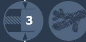
Fineline-Platten sind 3-schichtig aufgebaut. Die beiden Decklagen bestehen aus Furnierschichtholz mit senkrechten, schwarzen Leimfugen. Dadurch ergibt sich eine einzigartige, fein linierte und dekorative Oberfläche. Der Plattenaufbau ist durch ein Geschmacksmuster geschützt!
